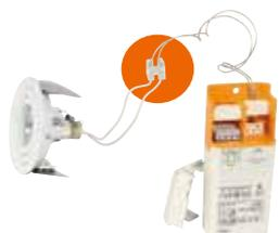
Le spot halogène choisi a un fil de sortie plus court que 20 cm et il vaut donc mieux l'utiliser avec un transformateur Niko à sortie de fil secondaire pour favoriser un raccordement aisé.
